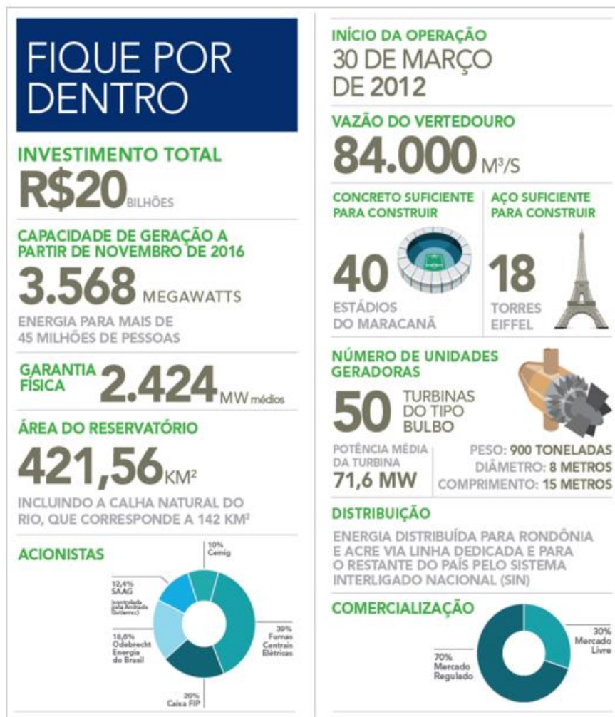
Figura 6: Usina em números. Fonte: Santo Antônio Energia. Disponível em: < http://www.santoantonioenergia.com.br/empresa/usina-em-numeros/ > Acesso em: 02 de maio de 2016.
