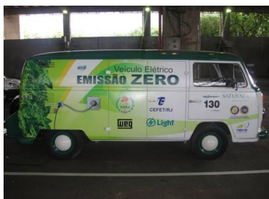
Figura 3 – Foto da Kombi Convertida para Tração Elétrica pela UERJ e CEFET-RJ
