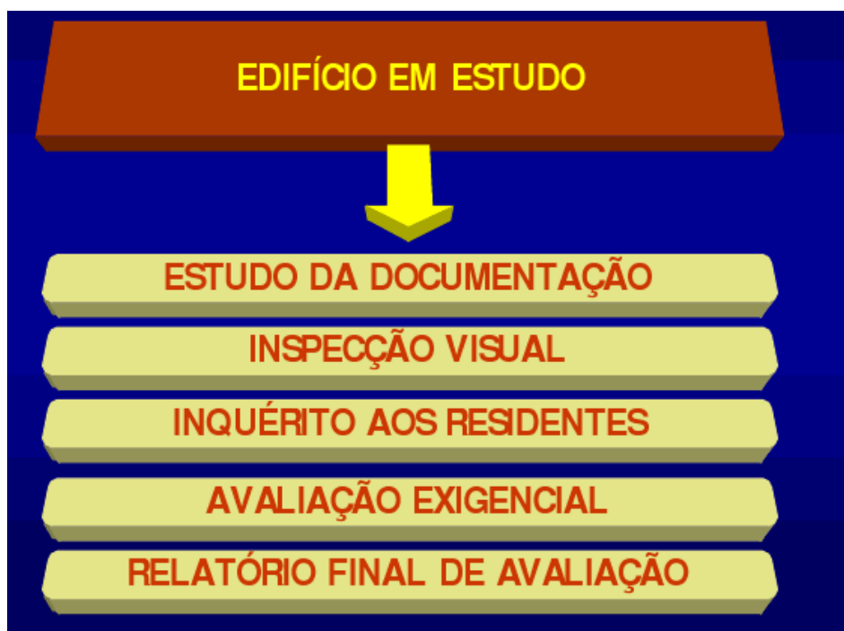
FIGURA 2 – Método do processo de reabilitação de edifícios.
