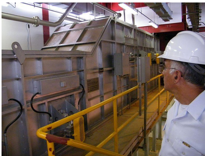
Figura 4: Forno para o processo de conversão do urânio em pó no gás hexafluoreto de urânio da Usina de Hexafluoreto de Urânio (Usexa), no complexo militar de Aramar, em Iperó (SP).
