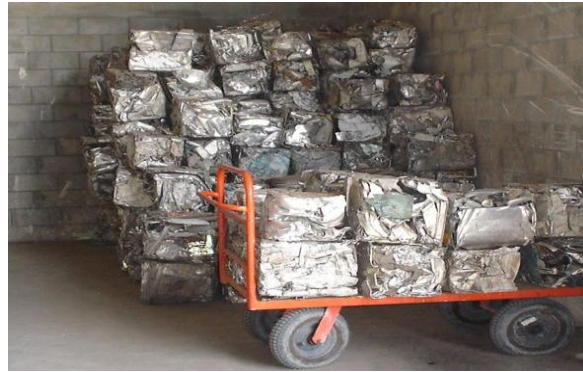
FIGURA 1 – Blocos de sucatas de alumínio. Fonte: GONTIJO (2009).
