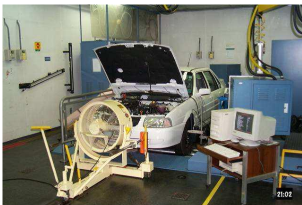
Figura 02 - Ensaio de veículo em banco de prova
